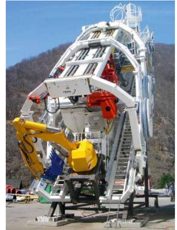
Einsatz einer Sonderbau-Einheit für die Verlegung von Wasserkraft-Druckleitungen
