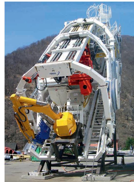
Utilisation d'une construction particulière pour la pose de conduites forcées
